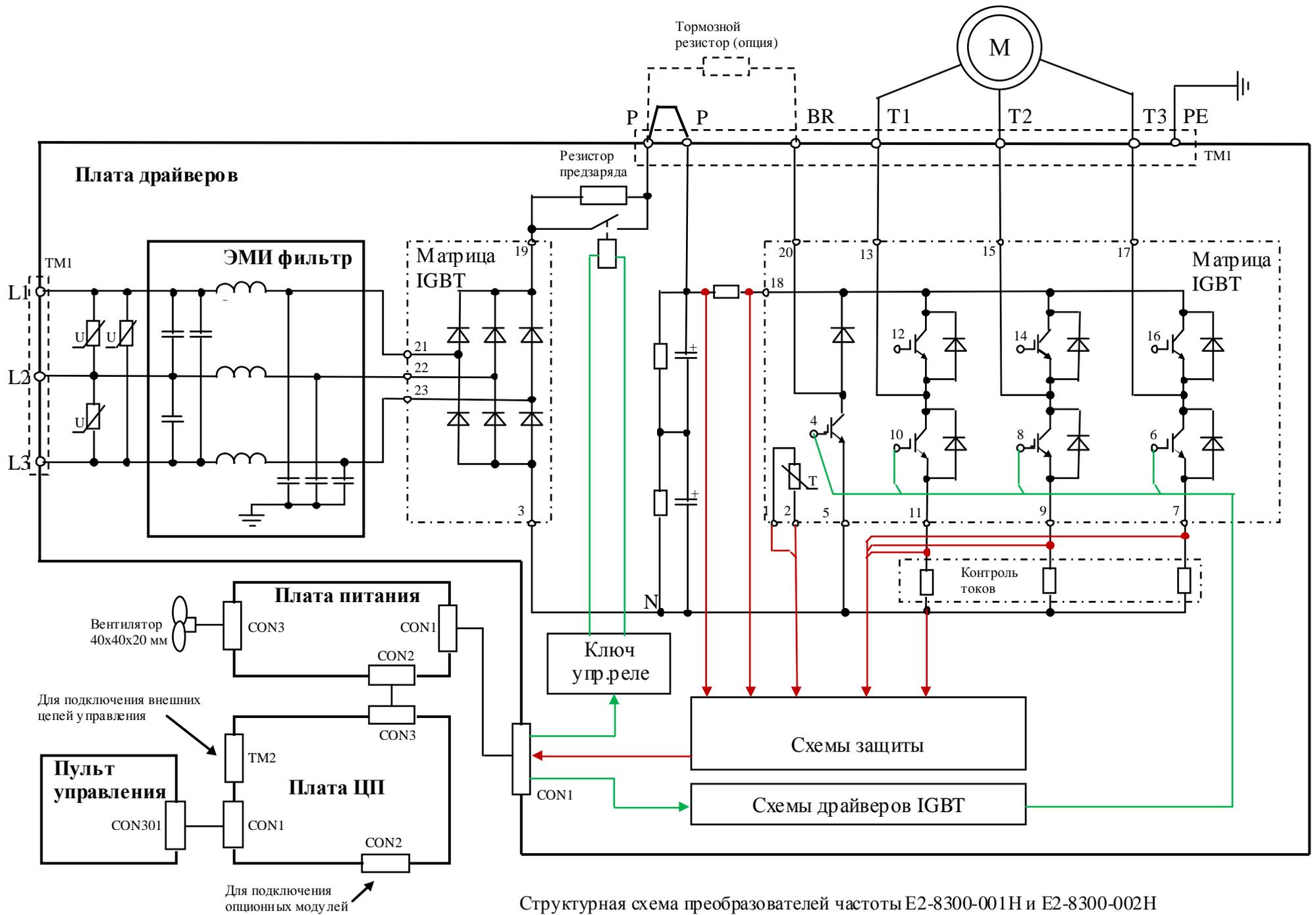
Структурная схема преобразователей частоты E2-8300-001H и E2-8300-002H
