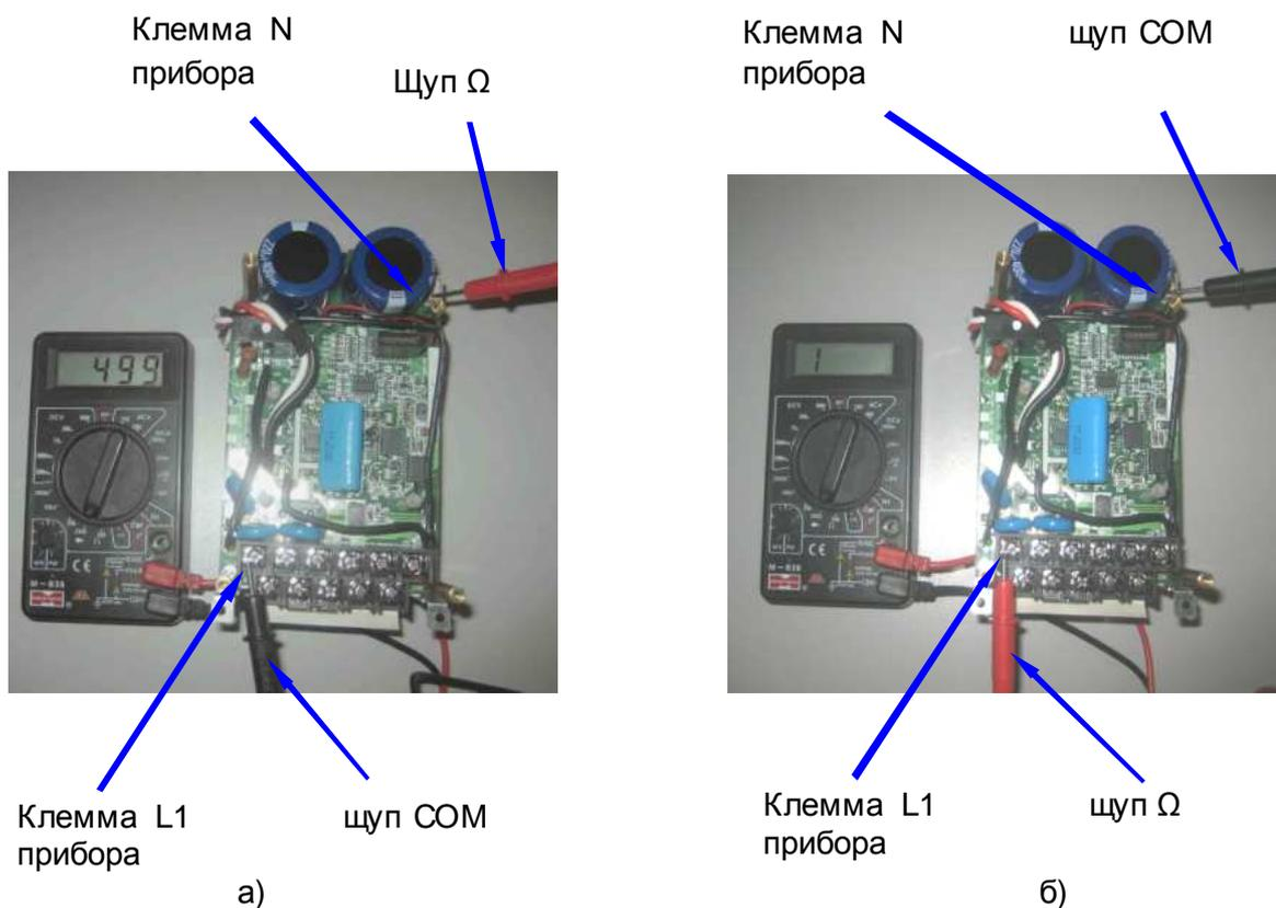
Рис 4.7. Диагностика матрицы относительно клеммы N
