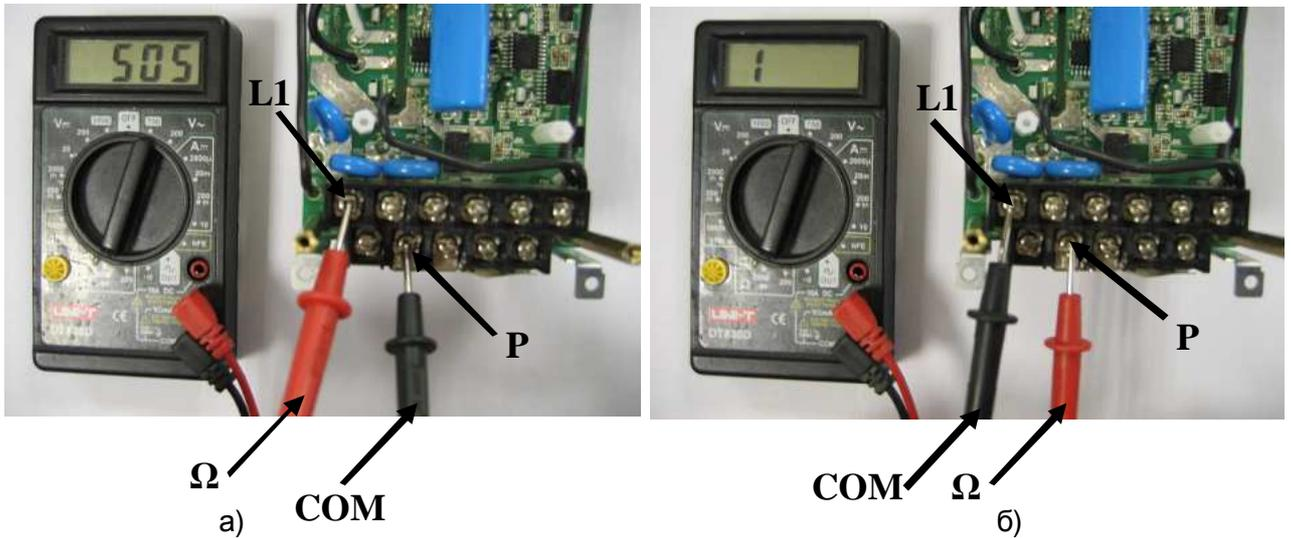
Рис.4.5. Проверка входных силовых цепей относительно клеммы P
