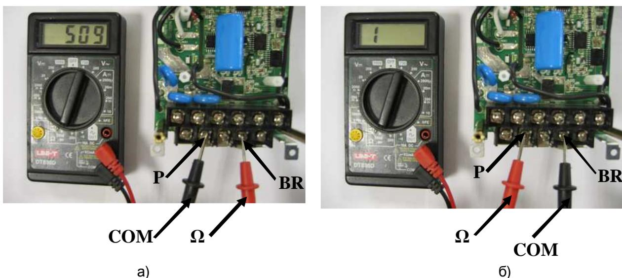
Рис 4.8. Диагностика ключа торможения относительно клеммы P
