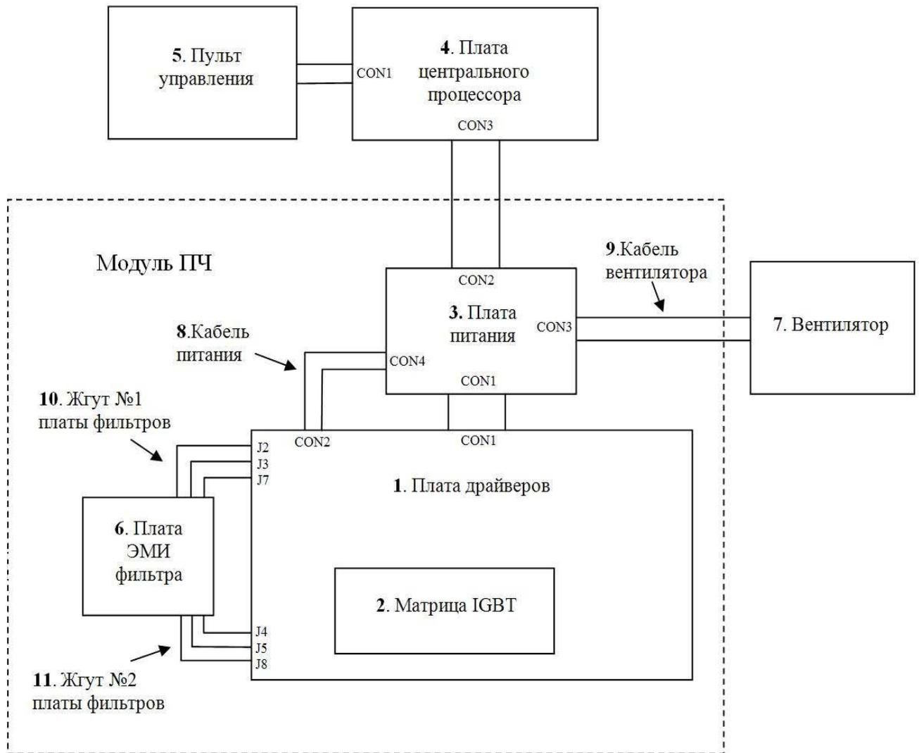
Рис. 4.2. Блок- схема преобразователей частоты E2-8300-001H и E2-8300-002H
