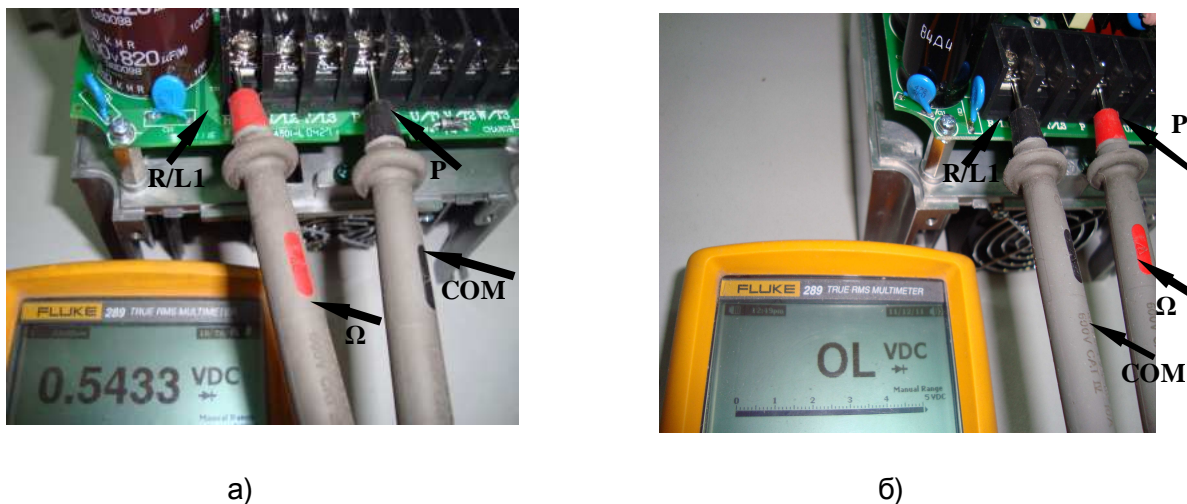
Рис.4.4. Проверка входных силовых цепей относительно клеммы «Р».
